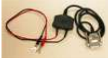
Давач для вимірювання сили струму \pm 100\text{mA} , \pm 2\text{A}
