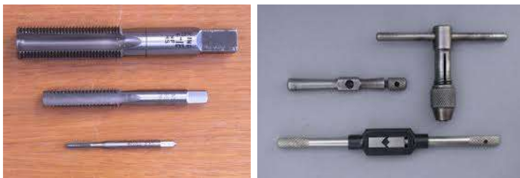
Рис.2. Інструменти для нарізання внутрішньої різьби різьби
