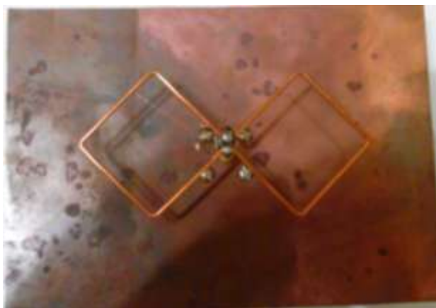
Рис.6 Виготовлена рамочна антена
