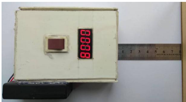
Рис. 1. Ультразвуковий дальномер з дисплеєм на базі платформи Arduino Nano 3.0
