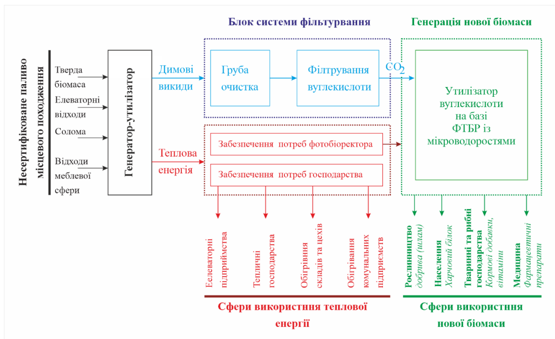
Рис. 1. Структурна схема комплексного використання генератора– утилізатора та фотобіореактора для нової біомаси
