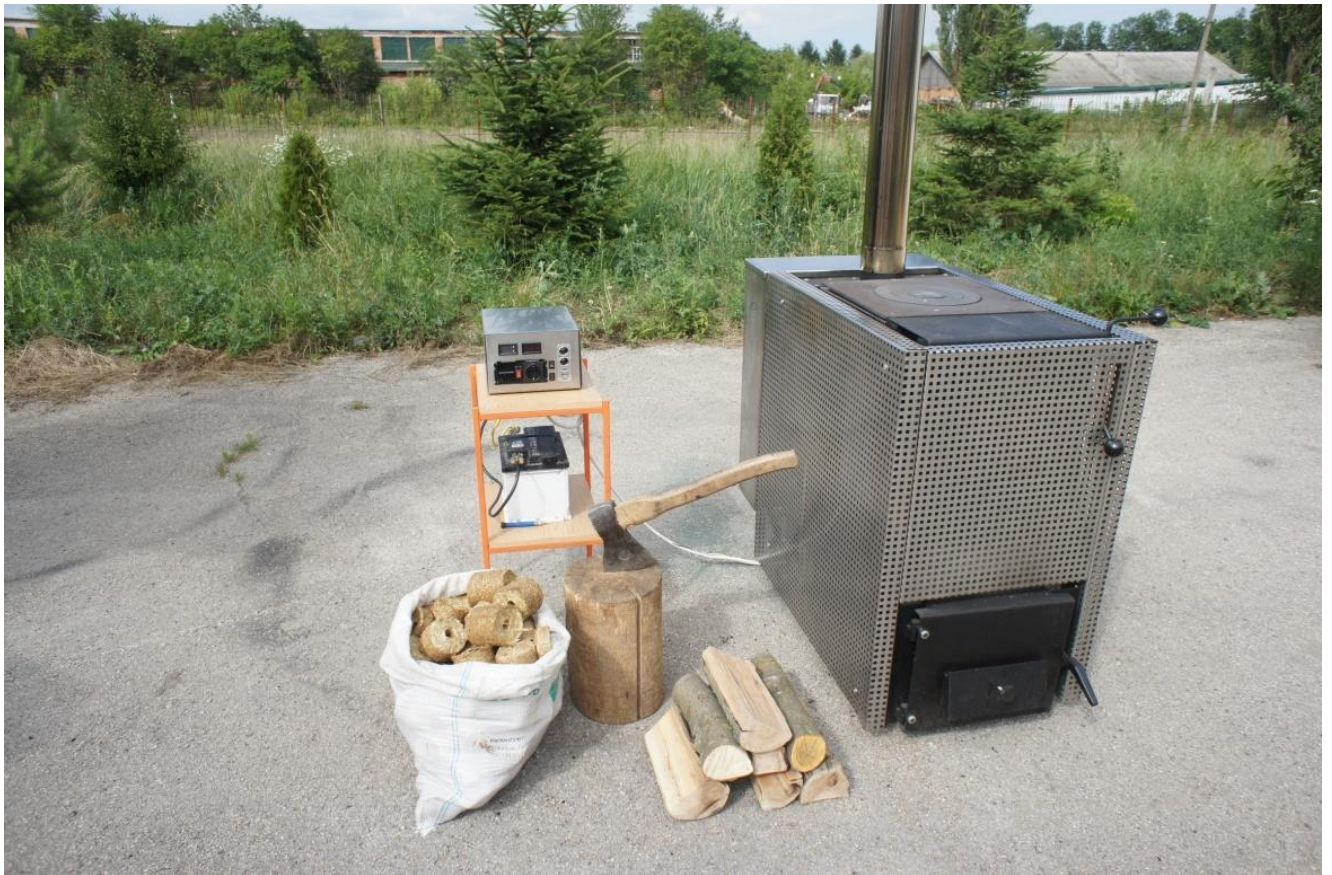
Рис. 3.40 Твердопаливний теплогенератор з когенераційною системою
