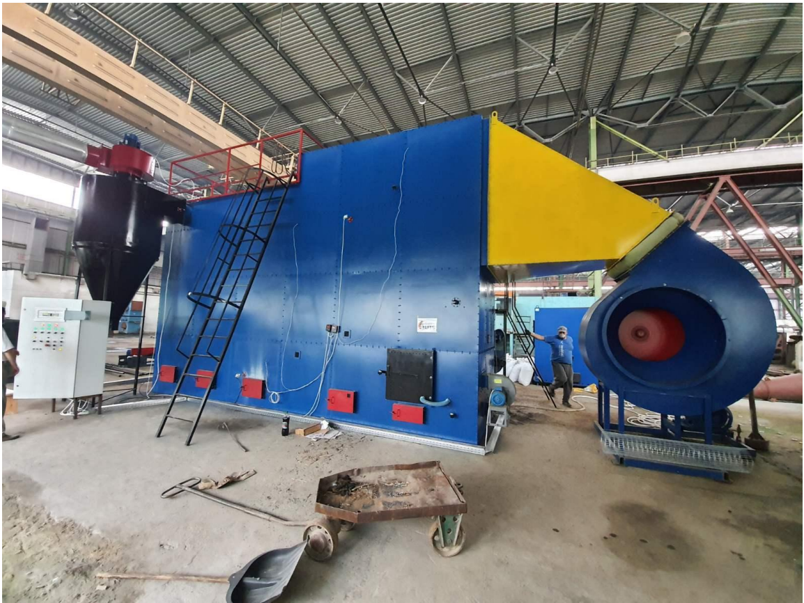
Рис. 2.7 Дослідний зразок теплогенератора-утилізатора 2500 кВт із принципом вихрового горіння несертифікованого палива
