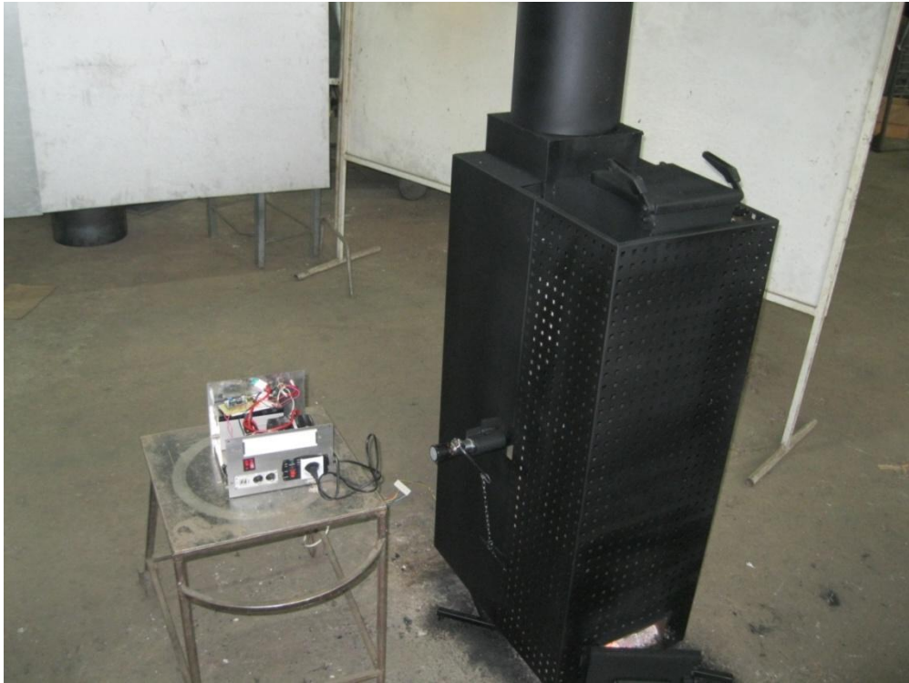
Рис. 3.39 Дослідний зразок автономної когенераційної системи електроживлення на базі біотеплогенератора
