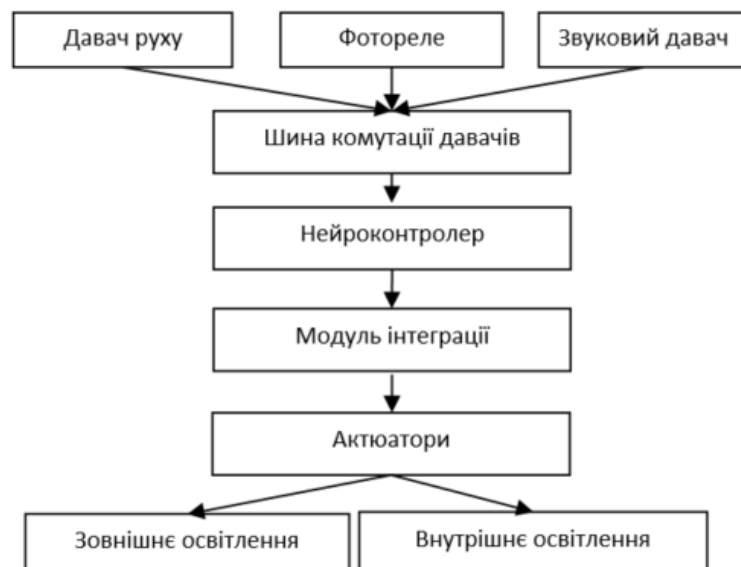
Рис. 1. Структура системи освітлення інтелектуального будинку
