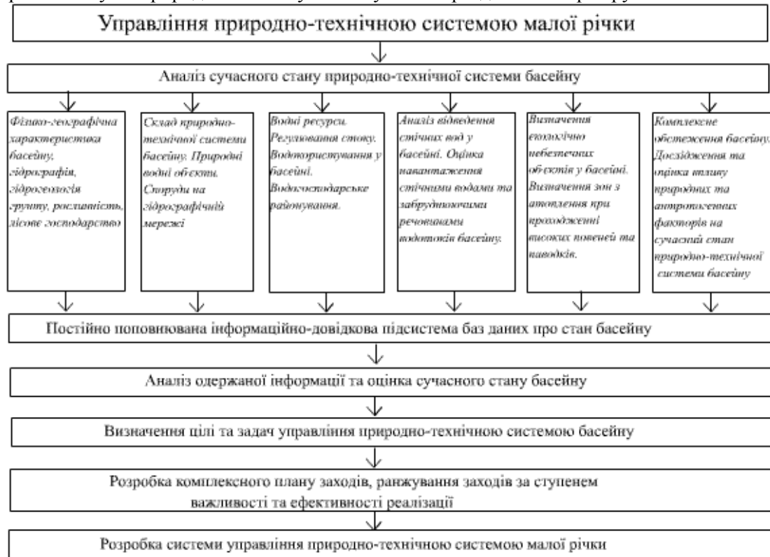
Рис. 4. Алгоритм розробки плану управління природно-технічною системою басейну малої річки
