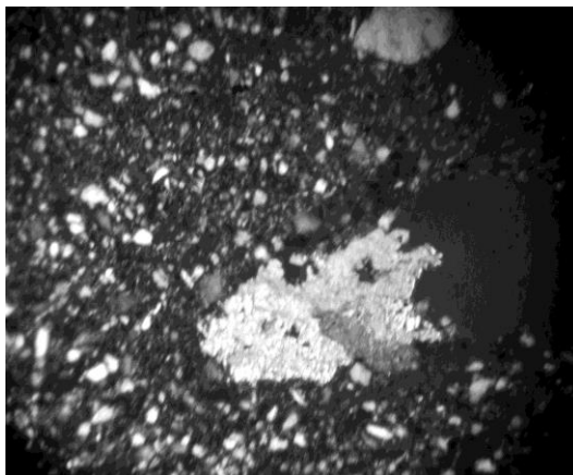
Рис. 1. Западинний варіант коршівського ґрунтоутворення: ґрунт другої фази. Горизонт H . Концентрація перекристалізованого кальциту в порі. \times 40 ; ніколи x .
