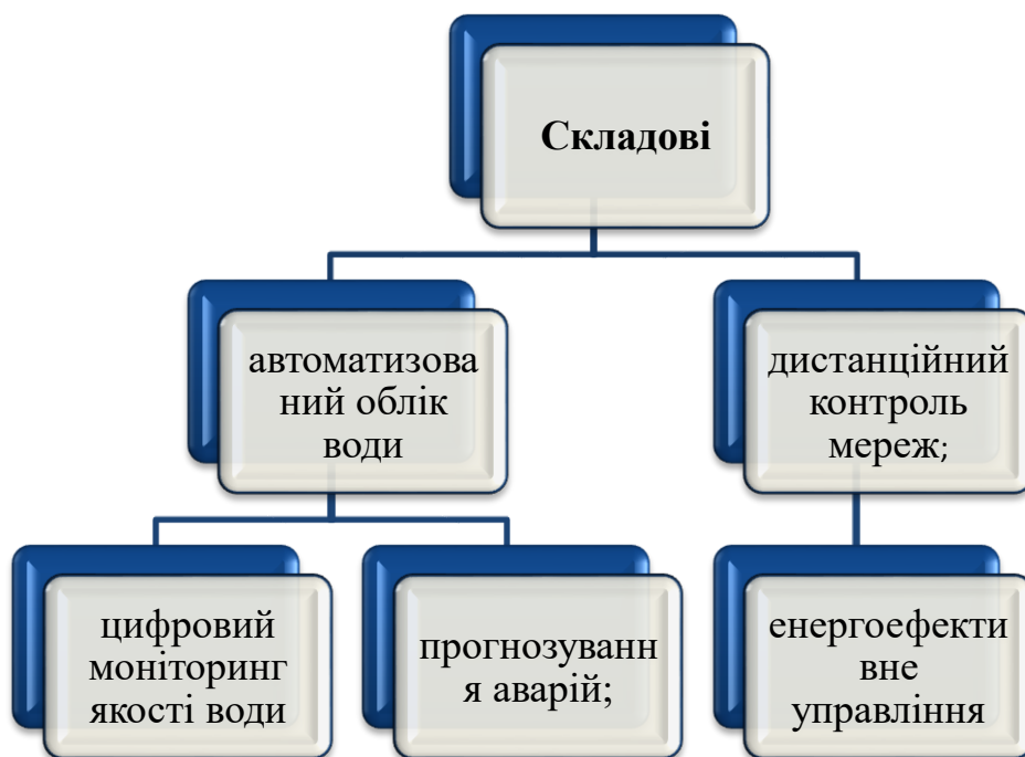
Рис.3.1 Складові smart water management
