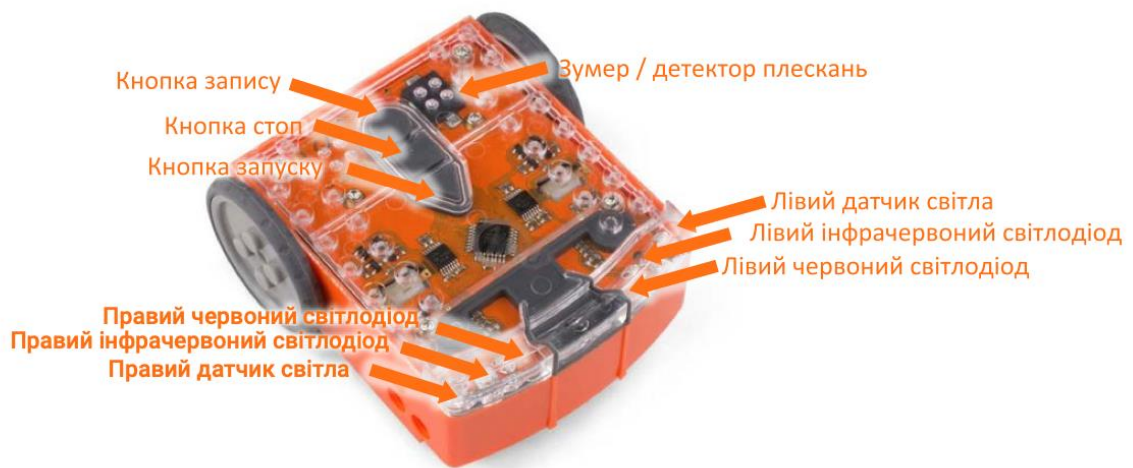
Рис. 1.18. Складові робота Edison
