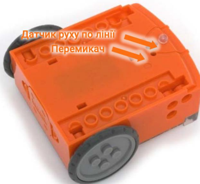
Рис. 1.19. Складові робота Edison
