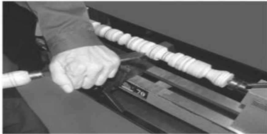
Рис. 1.3. Процес точіння балясини на токарному верстаті
