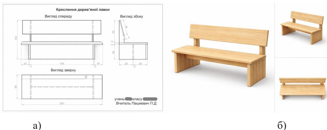
Рис. 3.2. Візуалізація в [Chat GPT]: створення реалістичного вигляду виробу «Лавка» за кресленнями: а - креслення; б - візуалізація виробу.
