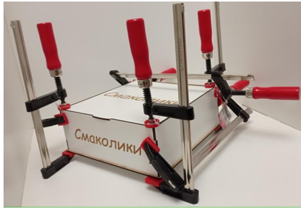
Рисунок 2.4 – Процес скріплення деталей скриньки між собою
