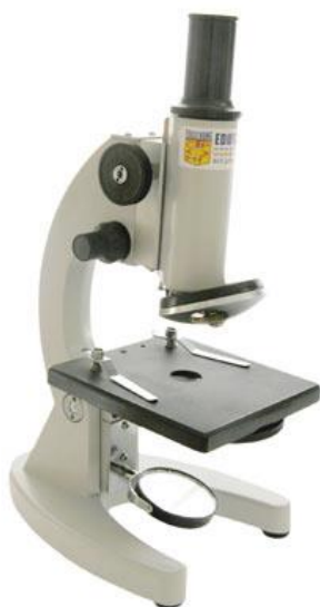
Іл. 1.21. Мікроскоп шкільний 2П-3М (з мікрогвинтом)
