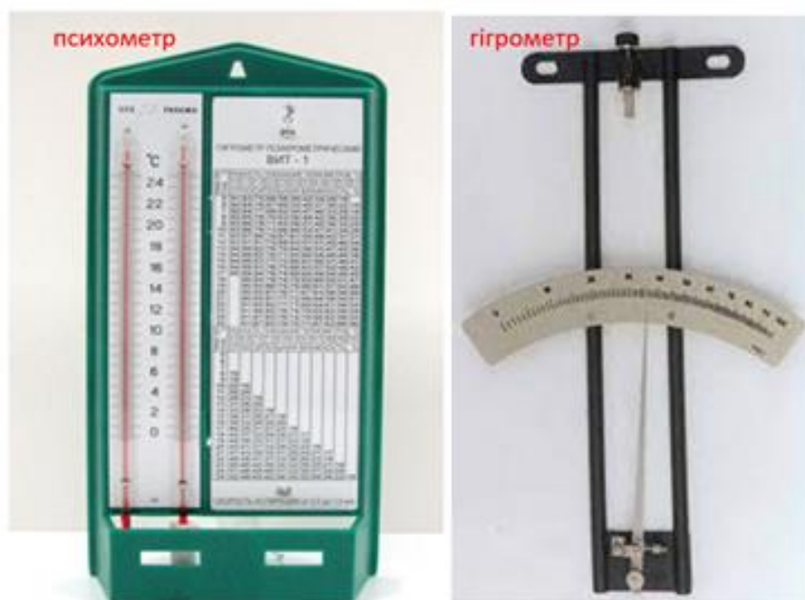
Рис.2.11. Психометр та волосяний гігрометр- прилади за допомогою яких вимірюють вологість повітря
