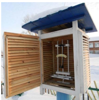
Рис. 3.16. Встановлення термометрів у метеорологічній будці
