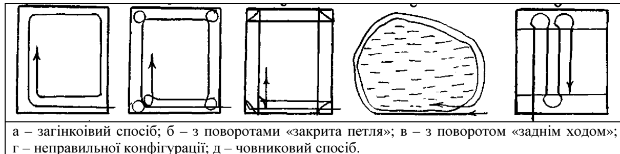
Рис.2. Узгодження технологічних операцій та схеми руху комбайна.
