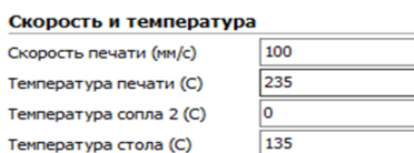
Рис. 15. Параметри швидкості та температури друку.
