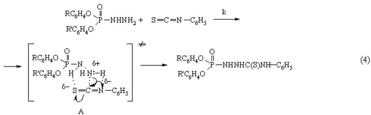
В реакції утворення тіосемикарбазидів має місце розрив двох зв'язків ( $N=C$  і  $N-H$ ) і утворення двох нових зв'язків ( $C-N$  і  $N-H$ ). Утворення в переходному стані A нового зв'язку  $C-N$  і розрив кратного зв'язку  $N=C$  в молекулі фенілізотіоцанату роблять можливим перенос протона від амінної групи гідразиду до ізотіоцанатної групи (утворення нового зв'язку  $N-H$ ), що і завершує процес утворення тіосемикарбазидів.
