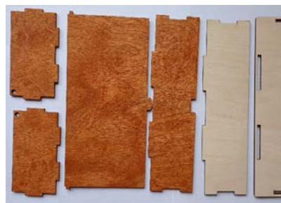
Рис. 3. Приклад коробки з одностороннім покриттям поверхні олією: а – деталі виробу покриті олією; б – виріб у складеному вигляді
