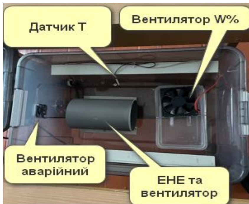
Рисунок 1 – Схематичне відображення камери інтелектуального інкубатора
