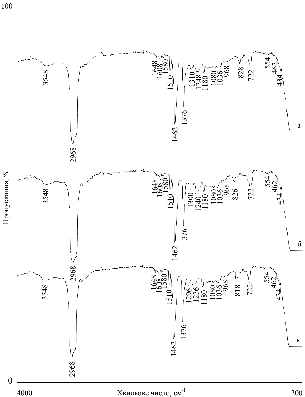
Рисунок 3. ІЧ-спектри поглинання епоксидної матриці при різних режимах обробки змінним магнітним полем: а – матриця, затверджена без обробки; б – матриця, при попередній обробці змінним магнітним полем; в – матриця, затверджена при дії змінного магнітного поля.
