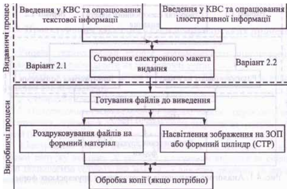
Рис. 2. Цифрова технологія виготовлення друкарських форм
